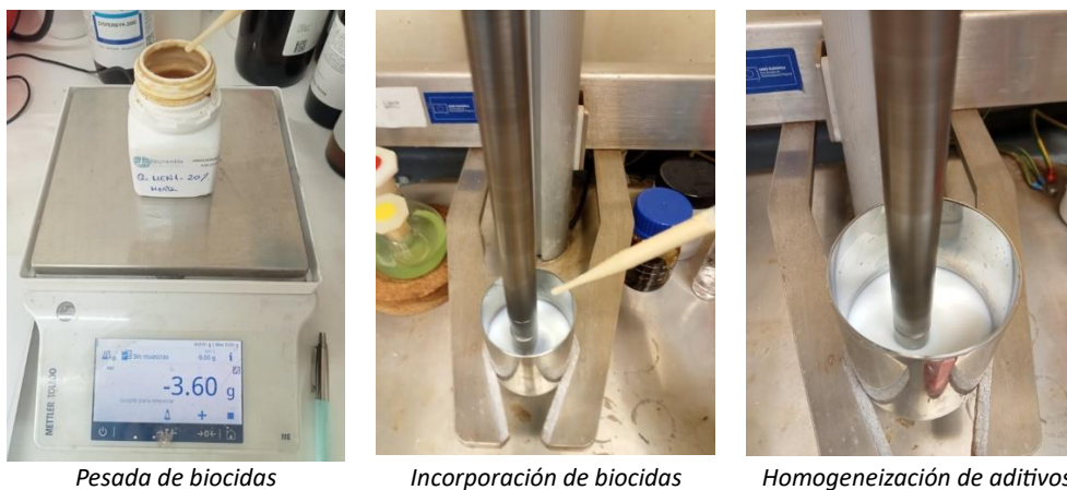
Figura 22. Proceso de elaboración de recubrimientos.
