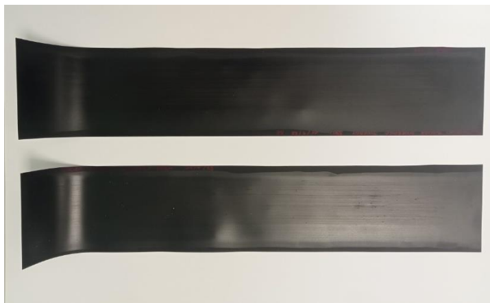
Figura 43. Aplicaciones para ensayo de resistencia al frote en húmedo con recubrimiento sinérgico FS 1.3.3 sometidas a 200 ciclos
