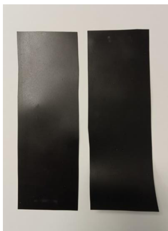
Figura 44. Probetas de área 7500 mm 2 para el cálculo de la densidad de la película seca. Referencias B1 y B2.
