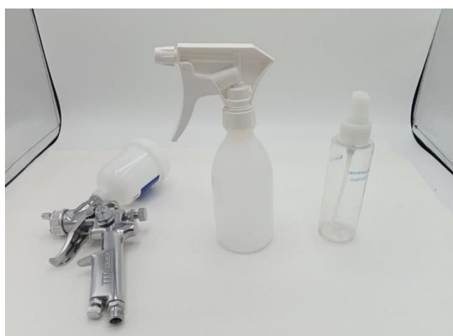
Figura 33. Métodos de pulverización empleados para aplicar el tratamiento sinérgico.
