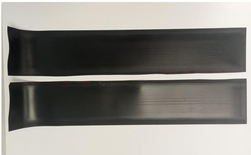
Figura 41. Aplicaciones para ensayo de resistencia al frote en húmedo con recubrimiento control FR 1.3 sometidas a 200 ciclos
