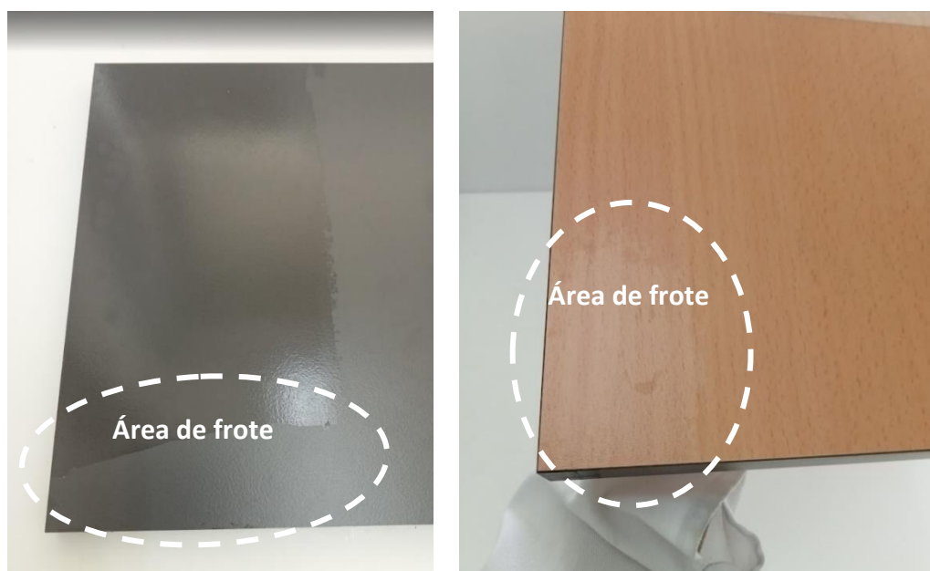
Figura 48. Resistencia a la adherencia de sustratos lignocelulósicos.
