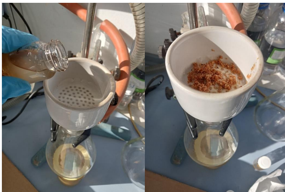
Figura 16. Proceso de filtrado de extractivos de T y MA en aceite de girasol.
