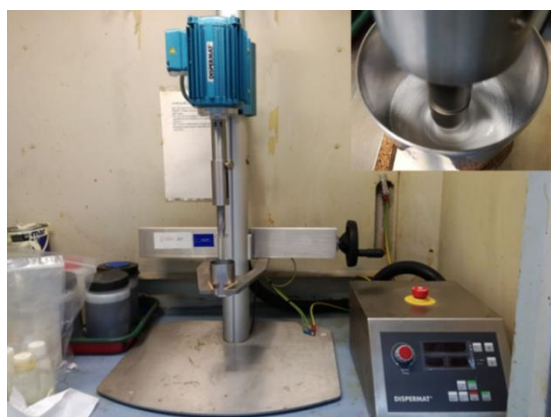
Figura 21. Equipo DISPERMAT utilizado para el desarrollo de los recubrimientos. Arriba a la derecha, zoom del proceso de agitación de una mezcla.
