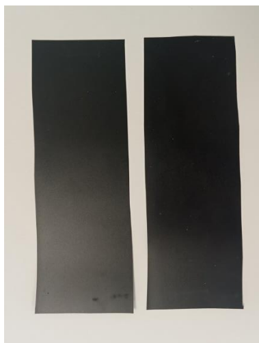
Figura 42. Probetas de área 7500 mm 2 para el cálculo de la densidad de la película seca. Referencias B1 y B2.
