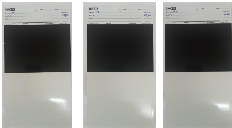
Figura 26. Aplicaciones sobre cartulina de contraste de las formulaciones FR1, FR2 y FR3, en húmedo (arriba) y en seco (bajo).
