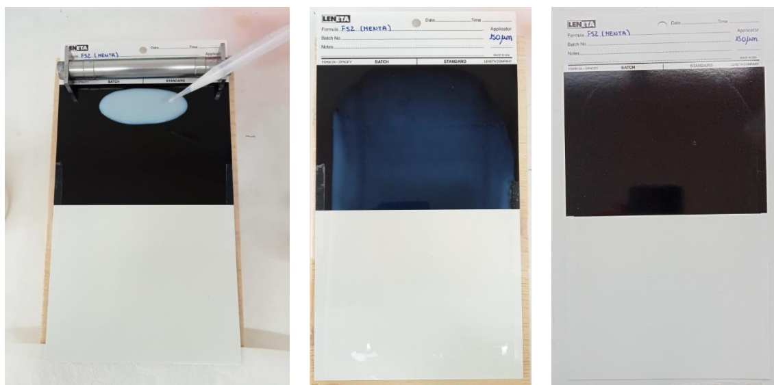
Figura 23. Soporte control y aplicador Baker cilíndrico (izquierda), aplicación húmeda (centro) y aplicación tras 24 horas de secado (derecha) sobre soporte control.
