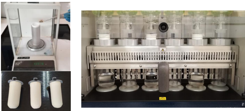
Figura 7. Preparación de biomasa de MA-F en dedal de celulosa y matraces con disolvente de extracción.
