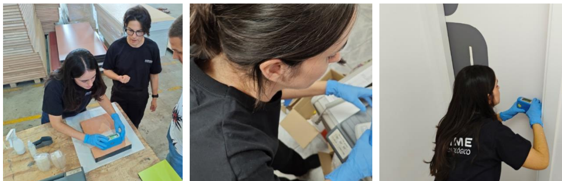
Figura 45. Medición de brillo de las diversas superficies tratadas en las instalaciones de las empresas colaboradoras.
