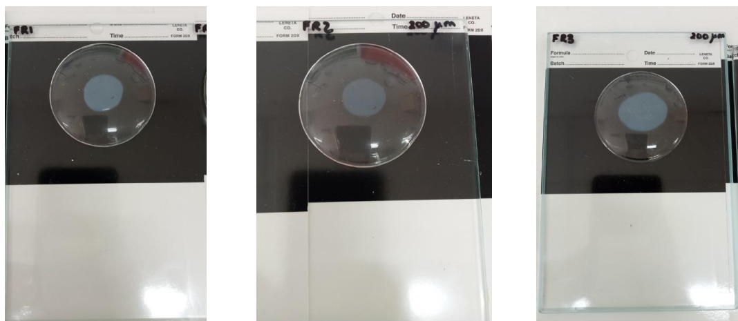
Figura 27. Comportamiento en contacto con agua. Aspecto de los recubrimientos tras 24 horas en contacto con una gota de agua.
